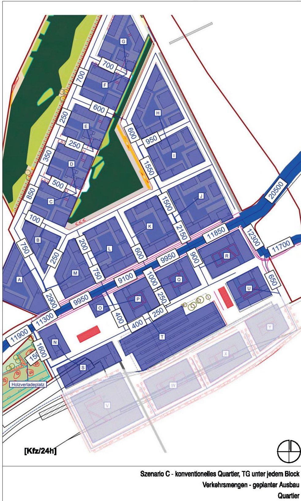
Abb. 4: Durchschnittliche tägliche Verkehrsstärken (DTV) des Kfz-Verkehrs der Nebenstraßen innerhalb des Quartiers Neckarbogen.
