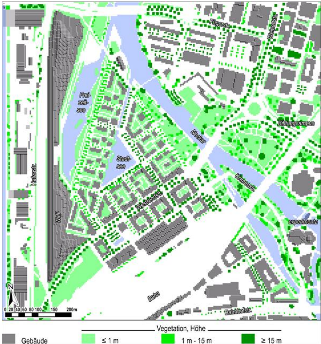
Abb. 4: Digitales Gebäude- und Vegetationsmodell in ENVI-met 3.1 zum Plan-Zustand des Untersuchungsgebietes „Heilbronn Neckarbogen“ (Darstellung mit 8° Nordabweichung. Wall mit 0,25 m hoher Grasnarbe und Bäumen, hier nicht dargestellt)
