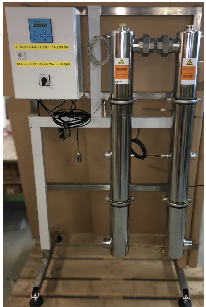
UV-Anlage mit Überwachung Maximalausführung
