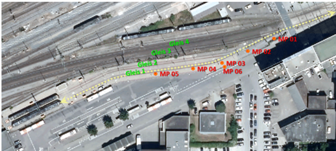
Abbildung 6: Verteilung der Messpunkte entlang des Untersuchungsbereiches, Bezeichnung der Gleise für die Messung der Züge
