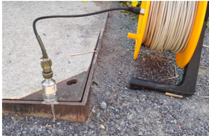
Abbildung 5: Befestigung eines Sensors auf der Umrandung eines Kanaldeckels
