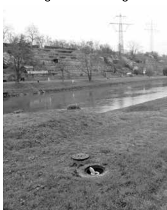
Bestandsgrundwassermessstelle am Wehr Beihingen / Quelle: WSV.de
