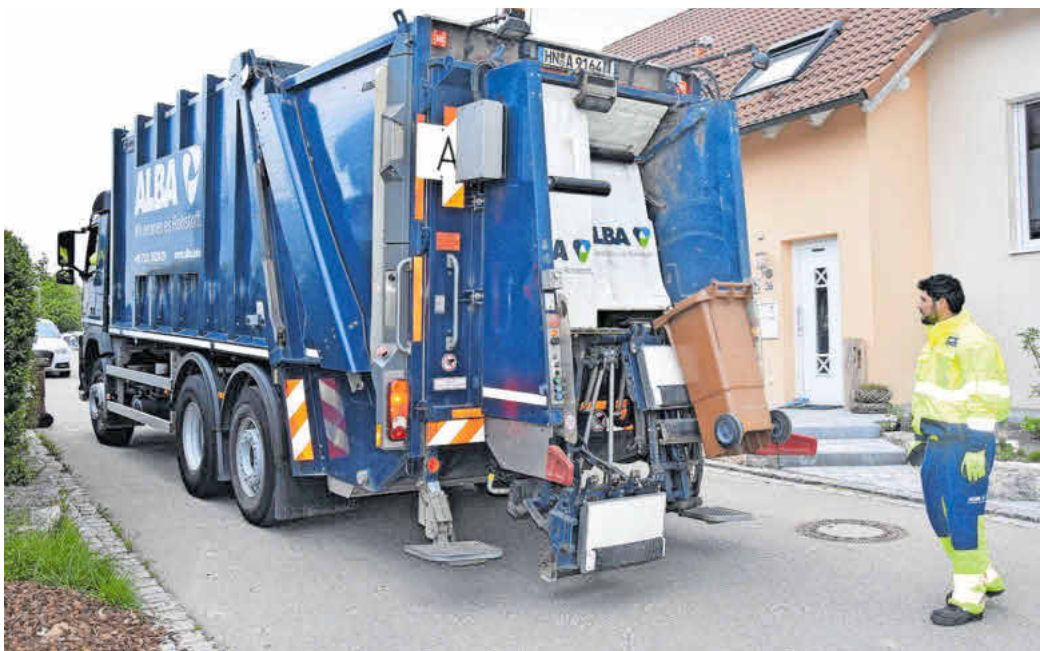
Ein neues Detektorfahrzeug – hier im Stadtteil Klingenberg – kann Bioabfälle auf mögliche Störstoffe untersuchen. Das Licht blinkt, wenn Störstoffe erkannt werden. Foto: Zhegrova
