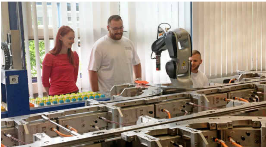
Praxisnahe - Schüler der Wilhelm Maybach Schule haben für die Lernfabrik 4.0 als Technikerarbeit eine Roboterzelle mit 6-Achs-Roboter aufgebaut und in Betrieb genommen. Foto: Markus Sütterlin
