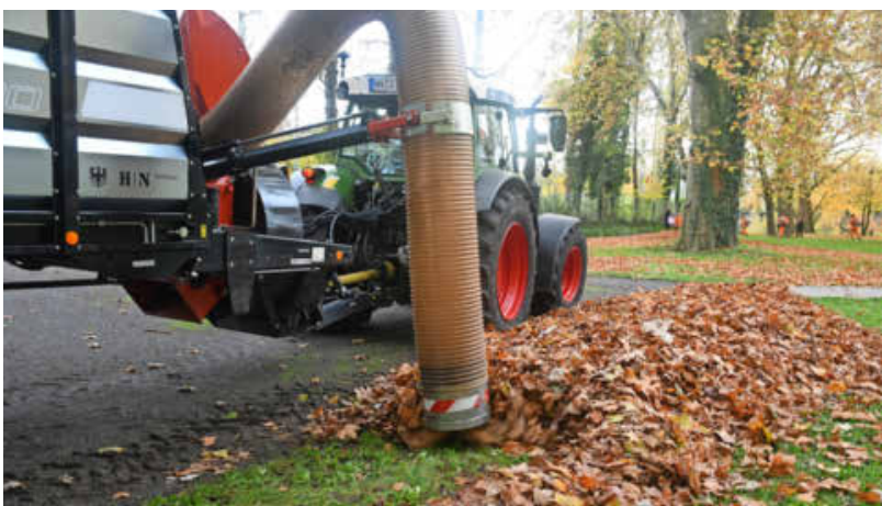
Der „Laubelefant“ saugt die geschichteten Blattmassen in einen Anhänger. Eine Turbine im Innern sorgt für die Saugkraft.
