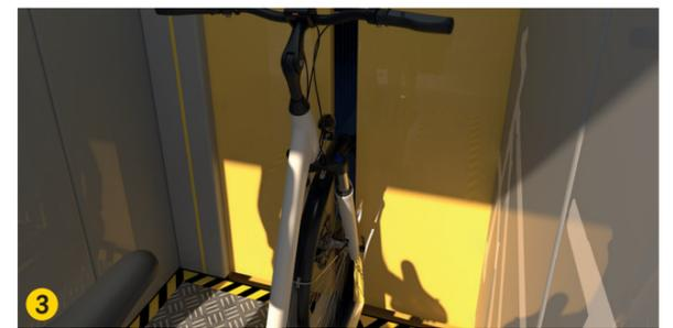
**3** Sobald sich das Tor einen Spalt öffnet, schieben Sie das Fahrrad mit dem Vorderrad bis zum Radanschlag, der sich hinter dem Tor befindet.
